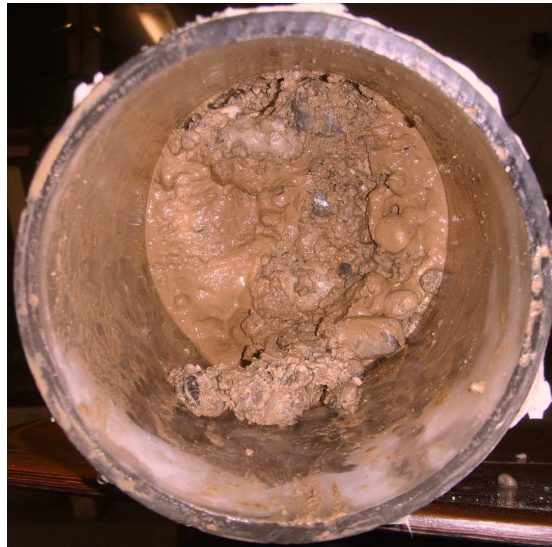
Abb. 3: geringdurchlässige Schicht 40 cm unterhalb der Säulenoberkante im 2. Säulenversuch Versuch (10 cm Rohrdurchmesser)
