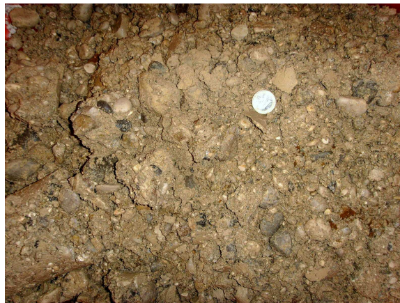
Abb. 6: gesättigtes Material aus der Bodensäule von Versuch 1, als Größenvergleich dient eine 1-Euro-Münze
