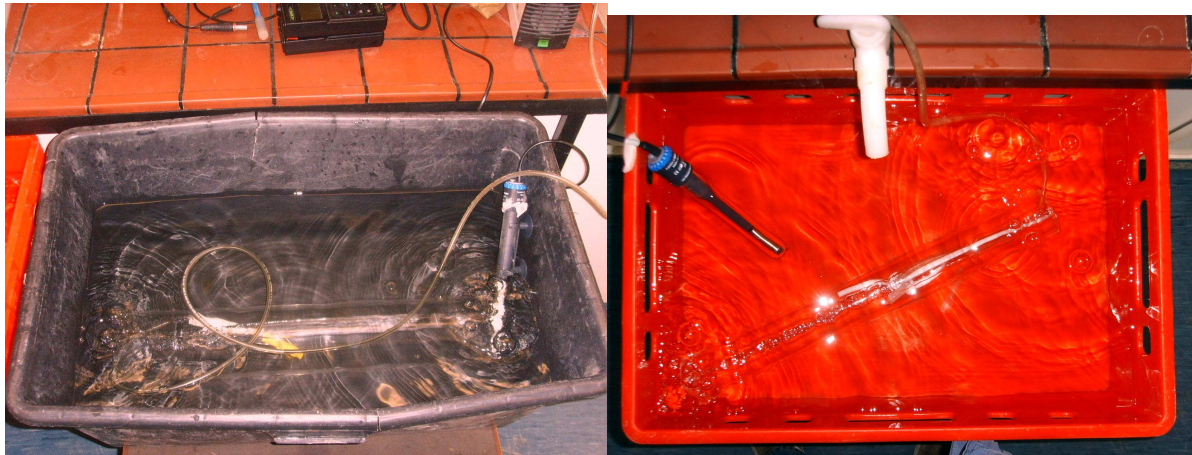
Abb. 3: Links Wanne 1 mit Heizstab 3604, rechts Wanne 2 mit Heizstab 3602. Zur Verlängerung des Luftstromweges wurden die Pumpschläuche in der Mitte von Plexiglasröhren deponiert.
